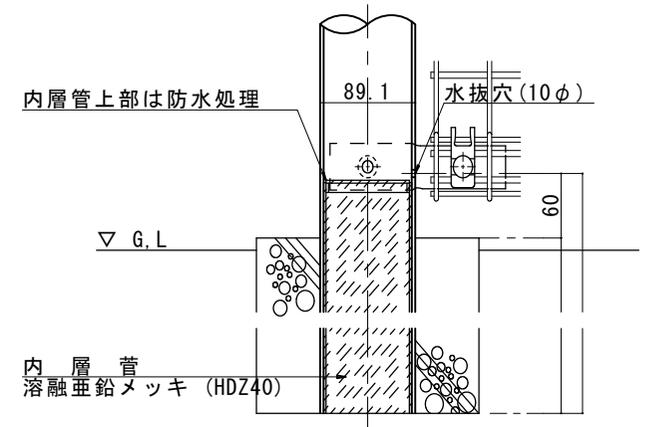
塩害対策支柱脚断面図 (1/5)
